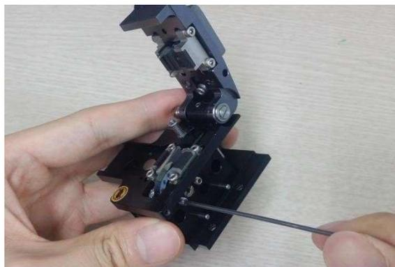
2. Вставьте ключ с нижней стороны скалывателя, как показано на рисунке, и выкрутите установочный винт из ползунка. Ползунки должны располагаться нижней стороной к себе.
