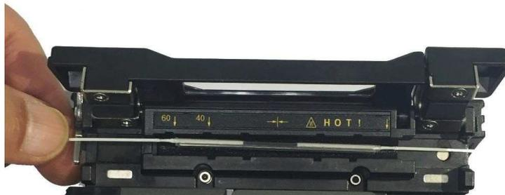
3. Опустите оптическое волокно вниз, как показано на рисунке, чтобы крышка нагревателя защитной трубки закрылась автоматически.
