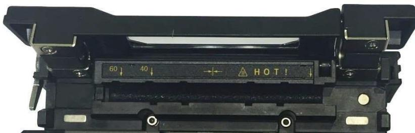
2. Установите защитную трубку на область сварки оптического волокна. Убедитесь, что центр защитной трубки находится на месте сварки волокон. Вставьте оптическое волокно внутрь нагревателя. В случае термоусадки защитной трубки коннектора расположите его с правой стороны нагревателя и вставьте трубку в нагревателе как можно плотнее к нему.
