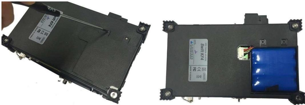
Аккумуляторная батарея установлена в батарейный отсек сварочного аппарата. Для замены аккумуляторной батареи выкрутите болты на нижней крышке. Пожалуйста, будьте аккуратны при извлечении аккумуляторной батареи из батарейного отсека.
