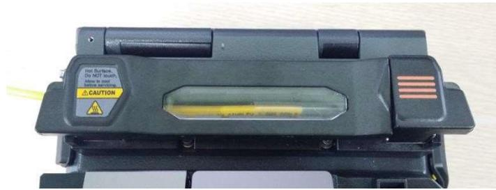
4. По завершении нагрева откройте крышку и выньте оптическое волокно с термоусаживаемой защитной трубкой.
