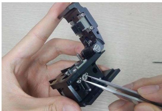
4. При замене будьте особенно аккуратны, чтобы не повредить лезвие. Сборка производится в порядке, обратном разборке; установочный винт следует надежно затянуть (левая резьба).
