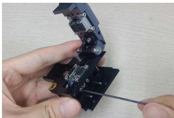
После того как установлена нужная высота лезвия, затяните установочный винт ползунка. Регулировка высоты лезвия во многом определяет качество скалывания. Регулировку высоты лезвия нужно обязательно проводить с использованием **BHS-01** (приобретается отдельно).
