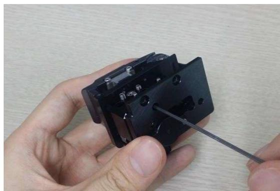
3. Выкрутите ось ножа отверткой с прямым шлицем (левая резьба), а затем снимите его с ползунка, потянув с помощью пинцета.
