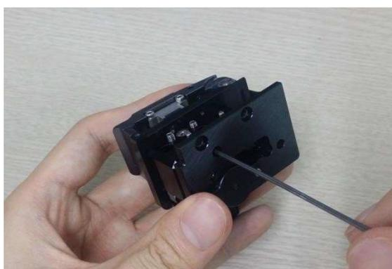
2. Для регулировки высоты лезвия поворачивайте ось кулачкового вала плоской отверткой. При повороте по часовой стрелке лезвие идет вверх. При повороте против часовой стрелки лезвие идет вниз.
