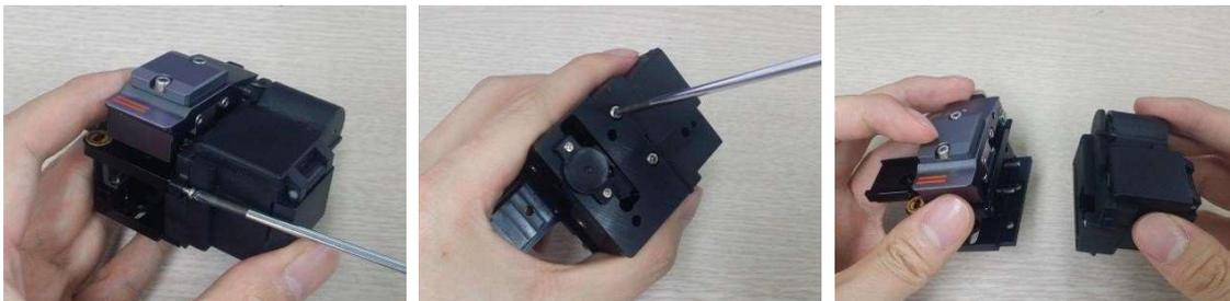
3. Откройте крышку; переместите ползунок, затем выкрутите установочный винт с помощью ключа, как показано на рисунке ниже.
